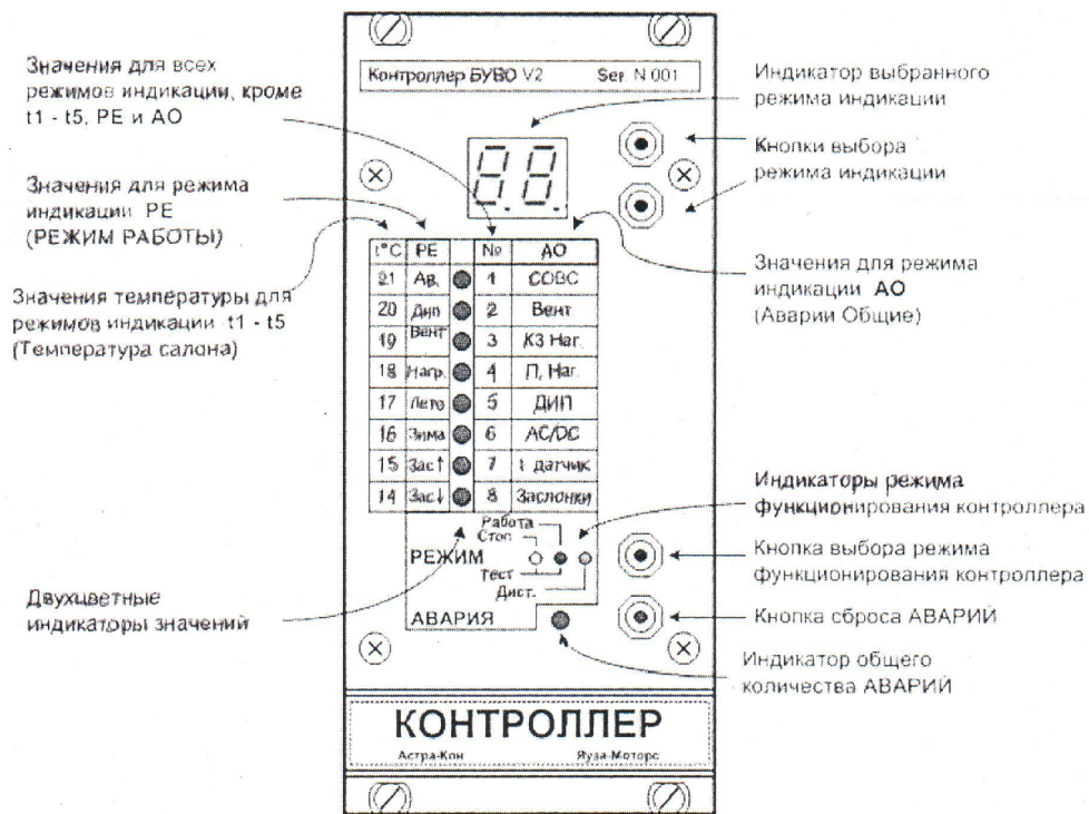
Рис.2 Передняя панель контроллера CO11.111.000.
